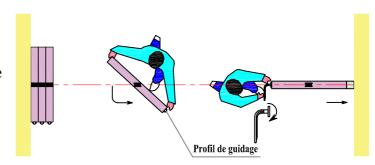
4.) Fermeture du dernier panneau (PMT): Introduire la clé de manoeuvre dans le logement prévu dans le dernier panneau.
