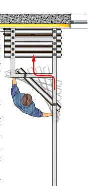
Ensuite poussez-le sur les panneaux déjà stockes. faites pivoter le panneau en suivant le cheminement du rail. vers l'avant, engagez le premier galet sur le rail de dégagement et 5 - S'il s'agit d'un mur mobile multidirectionnel, dégagez le panneau
